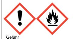
H315-Verursacht Hautreizungen. H412-Schädlich für Wasserorganismen, mit langfristiger Wirkung. H222-Extrem entzündbares Aerosol. H229-Behälter steht unter Druck: Kann bei Erwärmung bersten.
