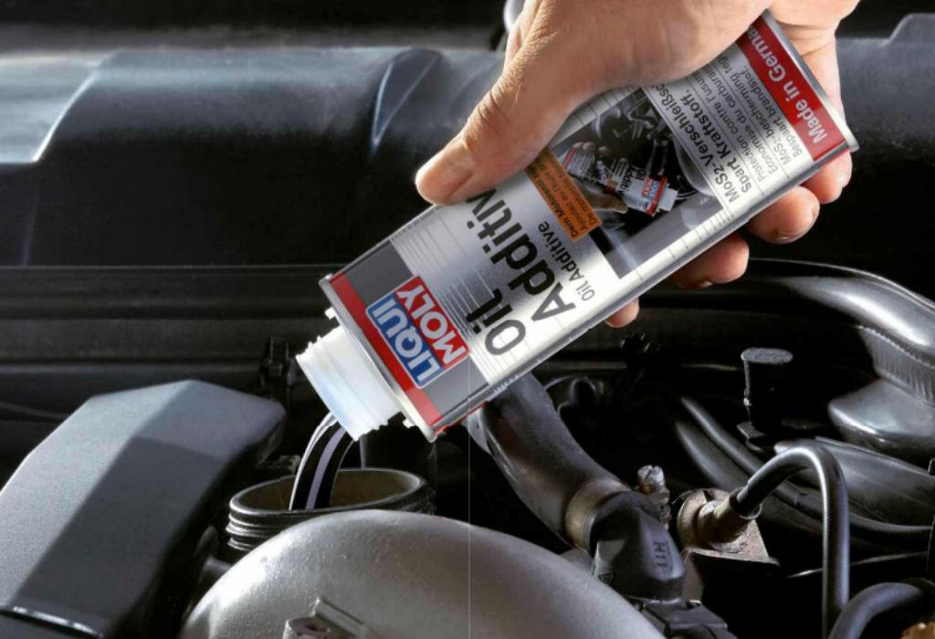
**DE** Motorenöl-Additive werden direkt in die Öleinfüllöffnung des Motors, gegeben und reinigen das System oder reduzieren die Reibung und den Verschleiß.
