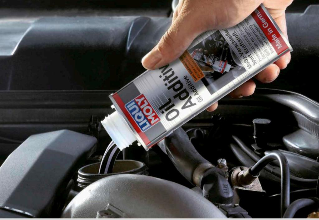
**NL** Motorolie-additieven worden direct toegevoegd via de olievulopening van de motor. Ze reinigen het systeem of verminderen wrijving en slijtage.
